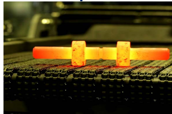
Тройная, двойная прокатка поковок гидравлических шестеренчатых насосов
