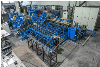
Линии поперечно-винтовой прокатки
