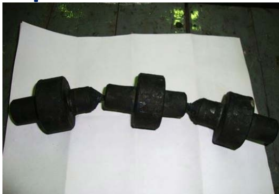
Тройная, двойная прокатка поковок гидравлических шестеренчатых насосов
