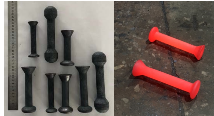
Стержни керамических изоляторов высоковольтных линий электропередач
