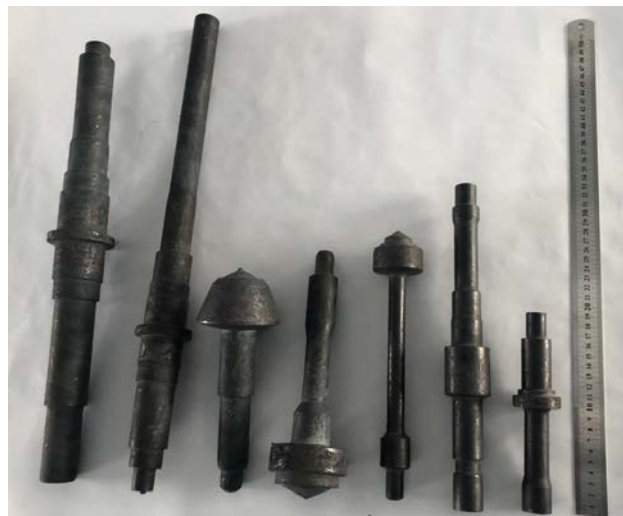
Прокатка поковок деталей подвески, рулевого управления, коробок передач
