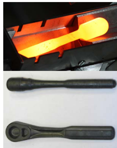
Одиная, парная прокатка поковок гаечных ключей
