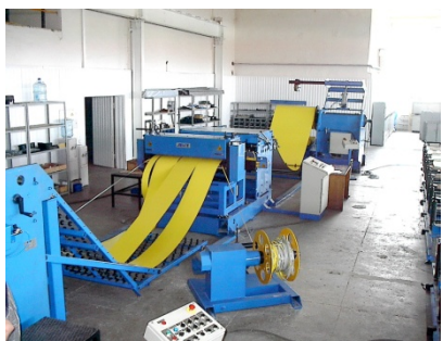
Линии продольно-поперечной резки металла
